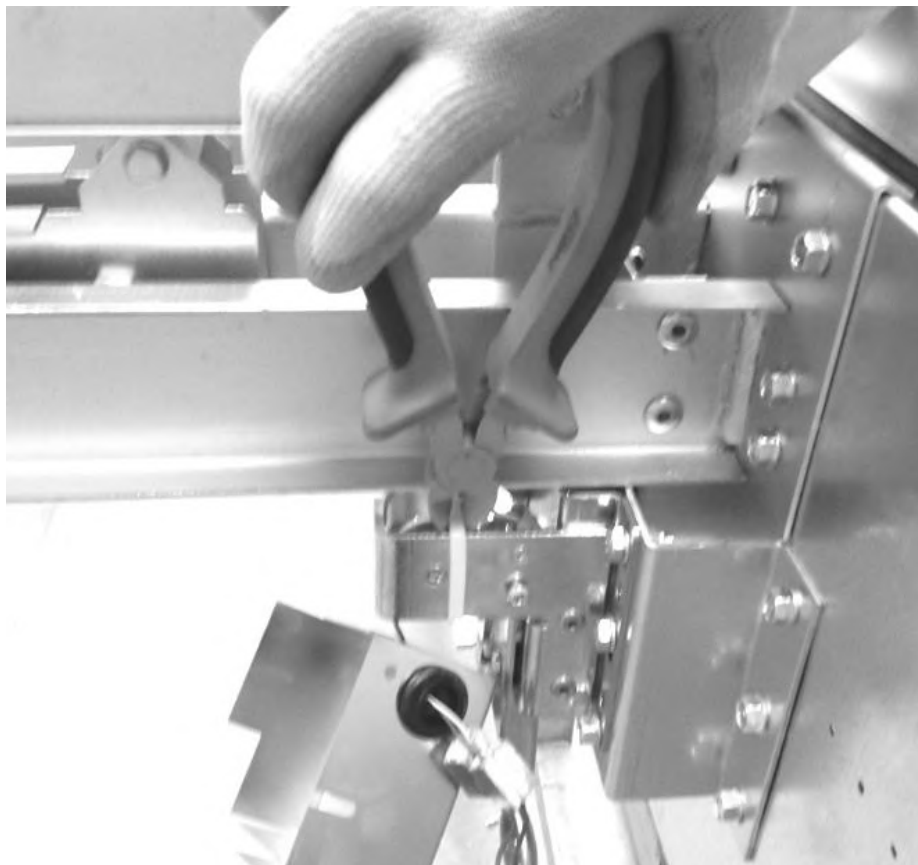
Rys. 41 Przycinanie opaski zaciskowej w celu odbezpieczenia zamka.
